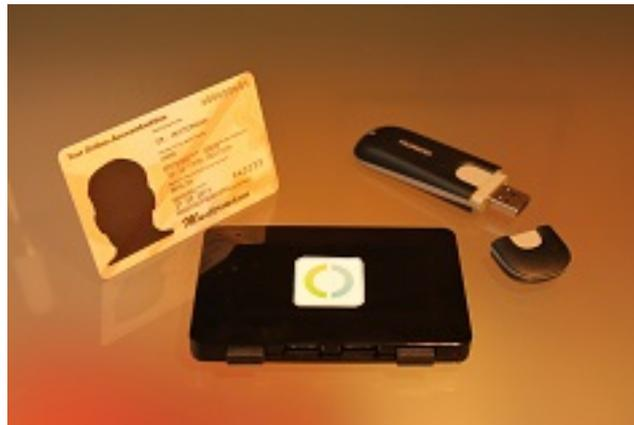
*Abbildung 1 Die SID-Box beinhaltet Betriebssystem, nPA-Kartenlesegerät und gegen BadUSB geschützte USB-Anschlüsse. Die SID-Box wird per USB an einen bootfähigen USB-Anschluss eines Standard-PCs angeschlossen. Der nPA wird zum Auslesen auf die SID-Box aufgelegt.*
